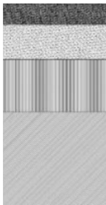
Surištų atsijų dangos skerspjūvis/struktūra.
